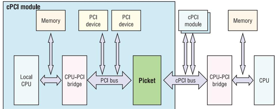
Picket выполняет функции PCI моста в модулях с внутренней PCI шиной, предназначенных для встроенных применений и представляющих собой систему на основе локального процессора. Picket совместим с процессорами, которые поддерживают PCI интерфейс.
